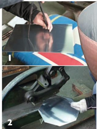
1 コンパスでアルミ板に円を描く 2 左手でアルミ板を回し、あつという間にカット
