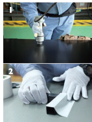
1 表面に傷や汚れがないか、機械でチェックする 2 出荷の際は傷がつかないように、テープでしっかり養生
