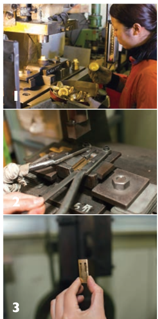
1プレス機で部品を加工、チェックも真剣 だ 2足で蹴る動力の機械（ケリポン1と 命名）で真鍮を折り曲げる 3できたの がバーナーの部品
