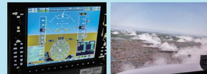
計器を確認しながら、高度と水平を保ちつつ飛行します。「ちょっと天気を変えてみましょうか」と、乱気流モードへ。さまざまな状況に対応できるよう、天候の変化や計器の故障などが設定できるそうです。
