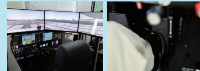
計器類がずらり。座ってすぐ操縦桿を握ろうとしましたが、「地上での移動や方向転換は、足もとのペダルを使います」と言われてびっくり。ペダルの上部を踏むとブレーキ、下を踏むと左右に動きます。
