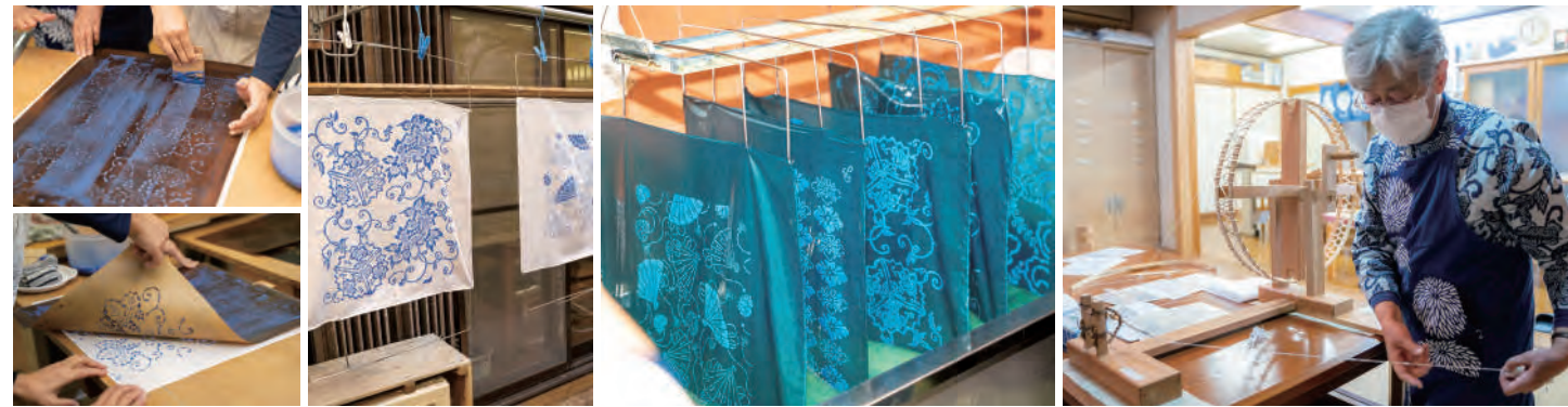
型の上に、染料を通さない糊を置く作業。糊の部分が白く文様として残ります。糊が乾燥したら染めの作業に。濃い色になるまで3回ほど染めます。右は、綿を糸にする糸紡ぎの様子。
