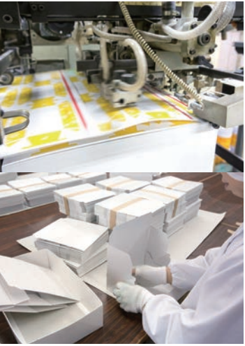
上/機械で紙を一枚ずつ送り、型を抜く 下/出来上がりの箱は、抜型職人とパッケージ職人のリレーの成果だ
