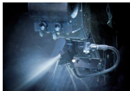
上/高圧クーラントによる噴射の様子。水道の蛇口を一杯ひねった状態の約200倍の水圧! 右/これが高圧クーラントだ
