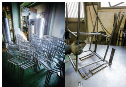
右/溶接したパイプを型から取り出している様子 左/ 同じイスのフレームがこんなにもある。会社では200種類 以上のイスをつくっている
