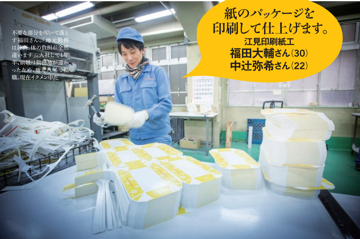
上/機械で紙を一枚ずつ送り、型を抜く 下/出来上がりの箱は、抜型職人とパッケージ職人のリレーの成果だ
