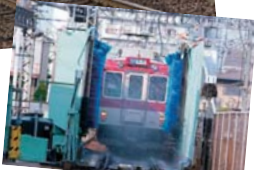
巨大なブラシが回転し洗剤と水 で電車を洗っていく洗車装置は 車庫の北端にある（MAP①）（提 供／近畿日本鉄道）
