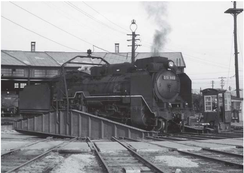
転車台に乗るD51940。機体の構造上、前向きでの運転を原則とする蒸気機関車では、駅や機関区の転車台で向きを整えた。この車両は関西本線木津以東の勾配区間を走行するため、集煙装置と重油タンクを装備(本人撮影/1969年12月20日)
